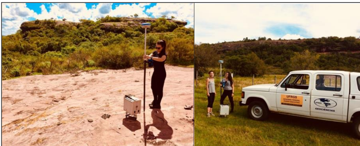
Figura 15- Aquisição dos dados de campo com o gravímetro Scintrex® CG-3 e rover (GNSS Stonex).
