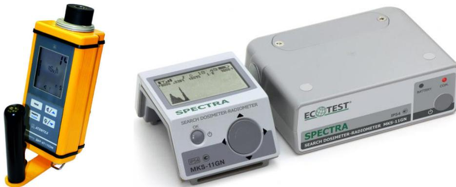
(a) Modelo AT1103M da Atomtex. Trata-se de um cintilador de NaI(Tl). (b) Dosímetro da Spectra (modelo MKS-11). À direita, o cintilador de CsI. À esquerda, o painel de controle. A comunicação entre as duas partes é feita via bluetooth.
