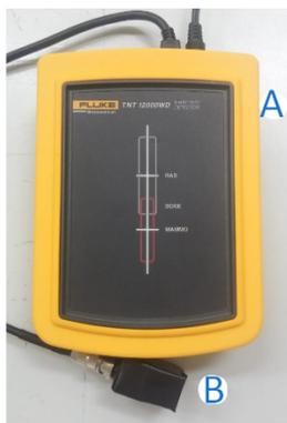
Figura 4.5: A) Detector referência. B) Detector PIN fotodiodo.
