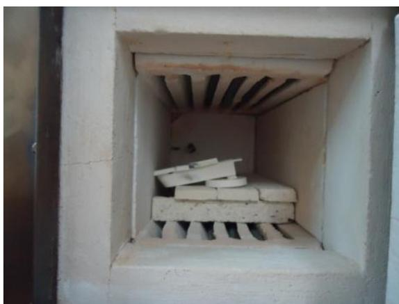
Figura 3.1 – Arranjo experimental do cadinho no interior do forno para crescimento de cristais de Bi-2212.
