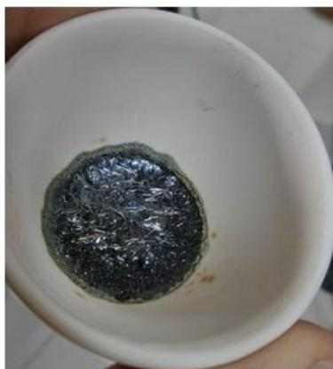
Figura 3.6 – Vista de cima do cadinho ao final do 3º procedimento de crescimento dos cristais de Bi-2212. Ao fundo vê-se o fluxo solidificado, com vários cristais sobrepostos.
