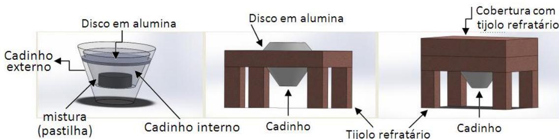
Figura 3.7 – Esquema de montagem dos cadinhos adotada no quarto procedimento.
