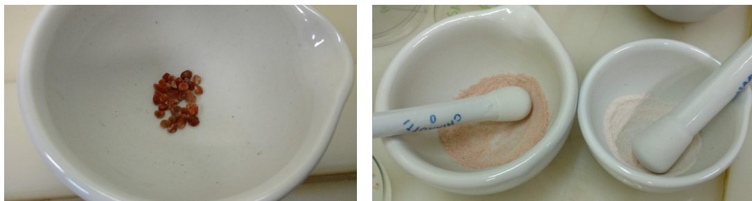
Figura 6: Grãos de sal antes e depois de serem moídos em um almofariz.
