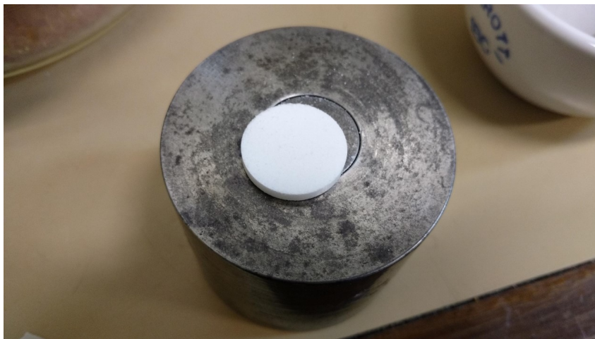
Figura 5: Pastilhador de aço utilizado na preparação de amostras, com uma amostra pastilhada de sal em repouso em seu topo.
