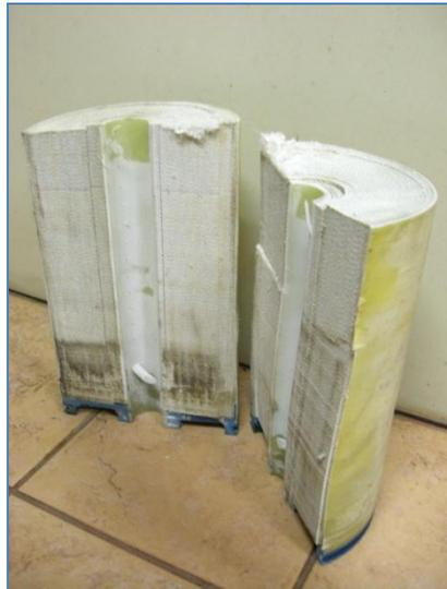
**Figura 3.4.** Fotografia de uma parte do módulo espiral da membrana dividido ao meio.
