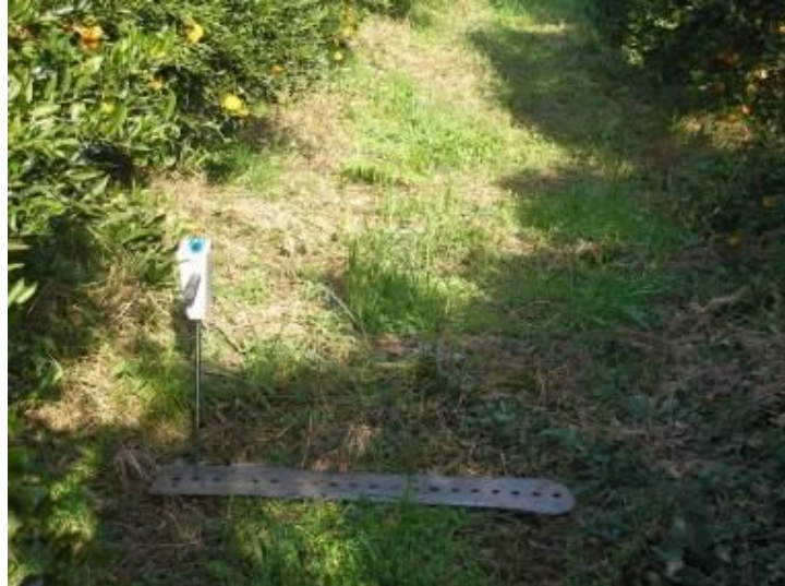
FIGURA 3: Placa de metal com furos utilizada para transecta de resistência mecânica à penetração. Montenegro/RS, 2008
