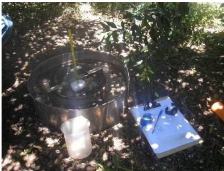
FIGURA 2: Ensaio de infiltração de água no solo com uso de anéis concêntricos. Montenegro/RS, 2008.
