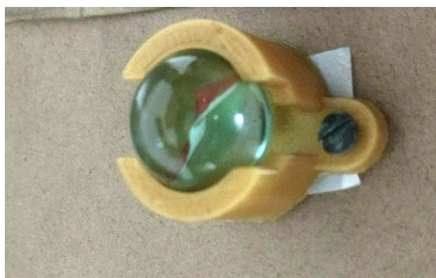
Figura 40: Roda de apoio - Suporte impresso em 3D Fonte: própria autora.
