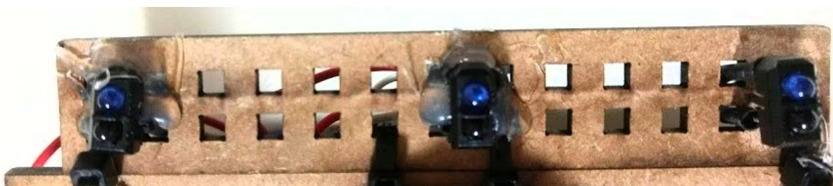
Figura 33: Sensores ópticos em seus locais definitivos, no “Carro Herói”. Fonte: própria autora.
