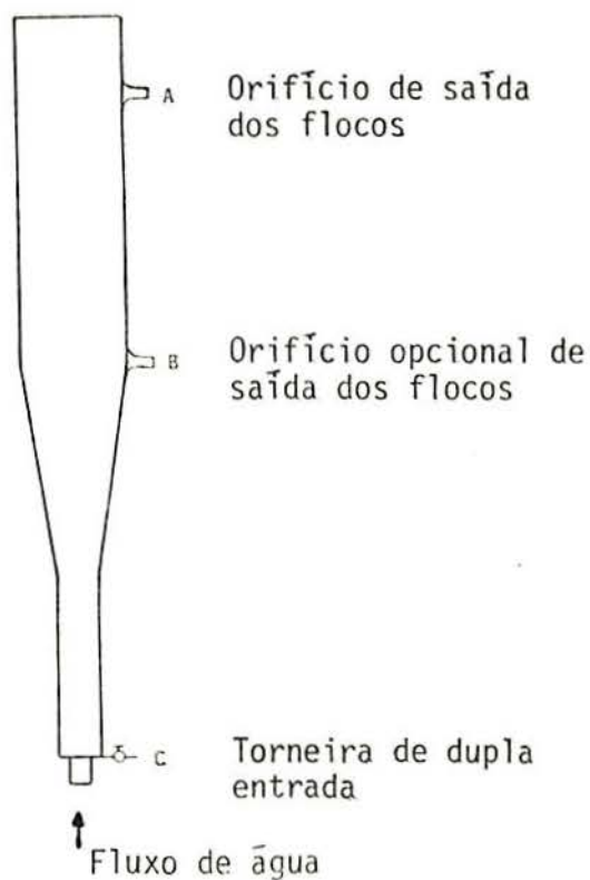
Figura 7 — Esquema de um elutriador
