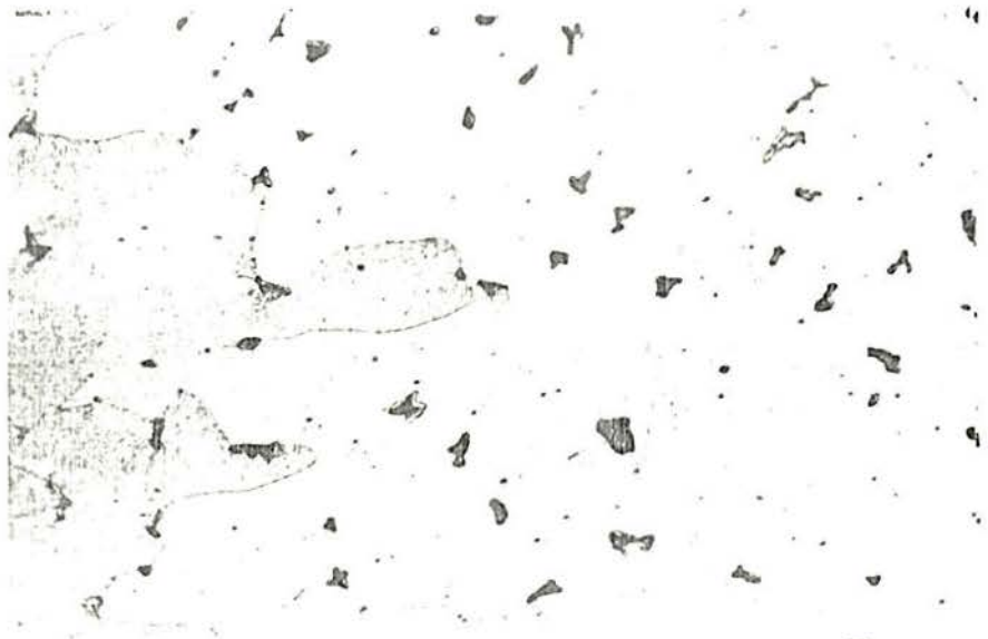
Figura 61 - Micrografia Lingote C A meio-raio da metade inferior Ataque: Dicromato de Potássio (200x)
