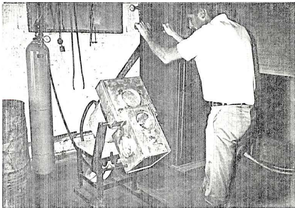
Figura 27 - Câmara de Atmosfera controlada montada, para teste de basculamento e manuseio.
