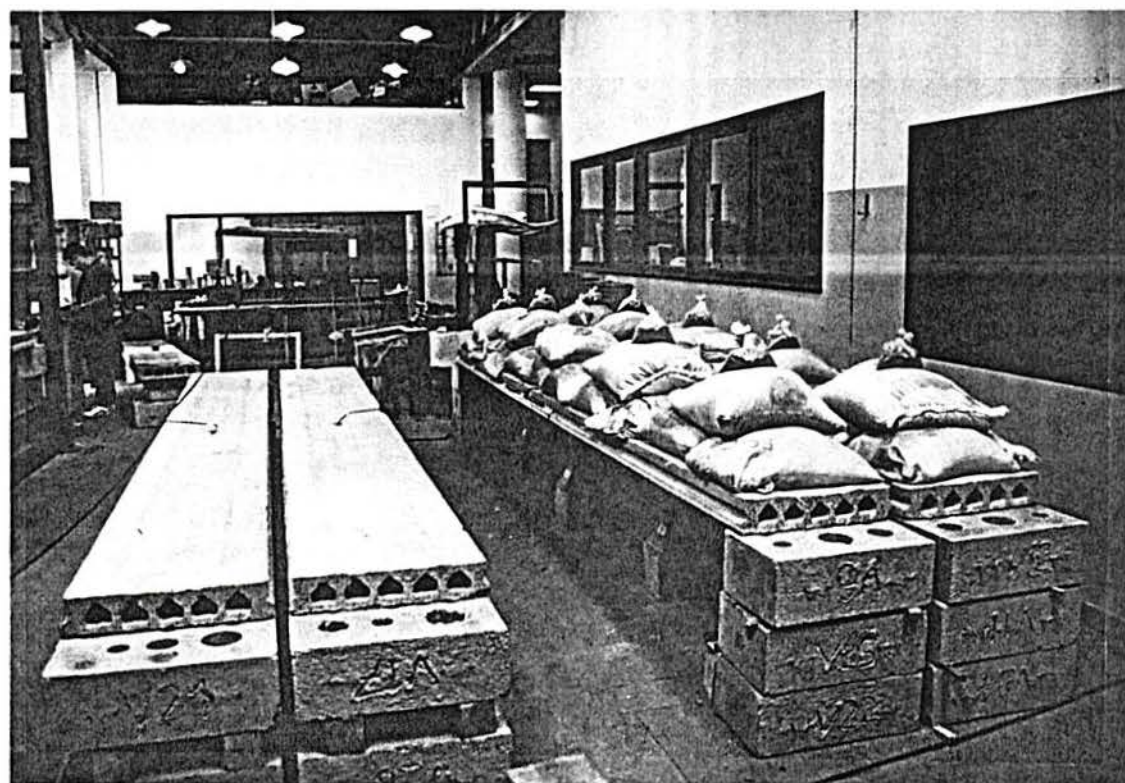
Foto 4.11 - Vista do protótipo B2, com carga de serviço total (1,65 KN/m) e execução de leituras no protótipo A1, após a segunda etapa de carregamento (1,0 KN/m). Vista dos equipamentos para a leitura das deformações dos strain gages
