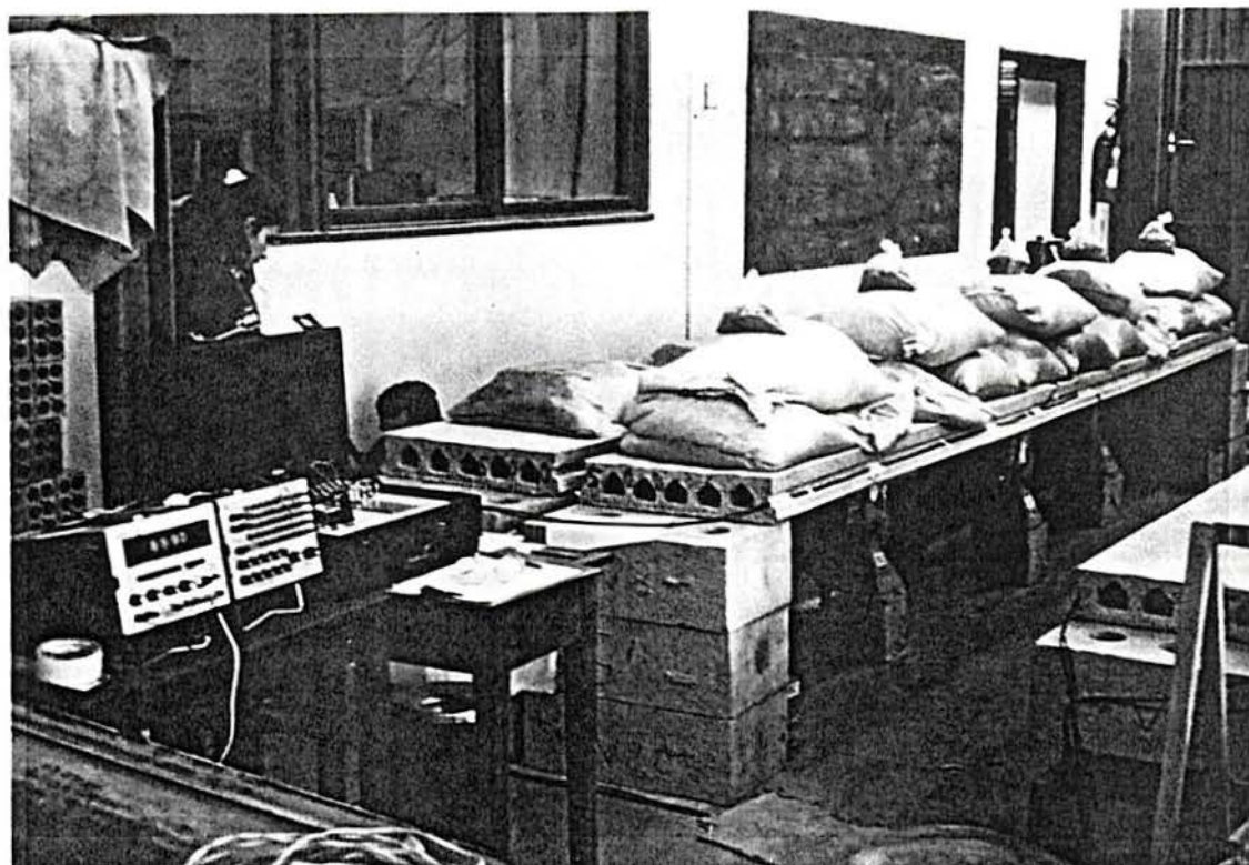
Foto 4.11 - Vista do protótipo B2, com carga de serviço total (1,65 KN/m) e execução de leituras no protótipo A1, após a segunda etapa de carregamento (1,0 KN/m). Vista dos equipamentos para a leitura das deformações dos strain gages
