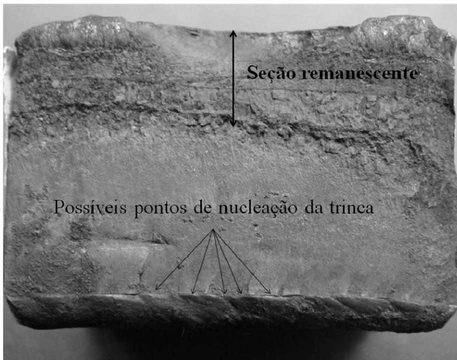
**Figura 4.11-** Superfície de fratura do corpo-de-prova CF 010, ensaiado a um  $\Delta\sigma$  de 284 MPa no meio corrosivo, rompendo com um número de ciclos  $N = 288.105$ .
