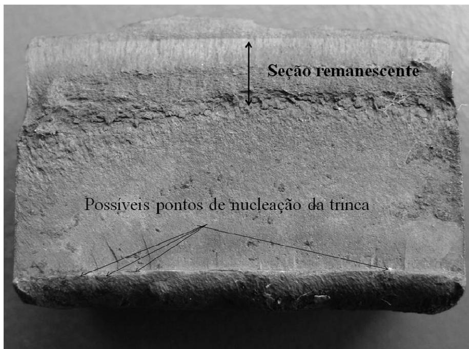
**Figura 4.12-** Superfície de fratura do corpo-de-prova CF 005, ensaiado a um  $\Delta\sigma$  de 236 MPa no meio corrosivo, rompendo com um número de ciclos  $N = 226.316$ .
