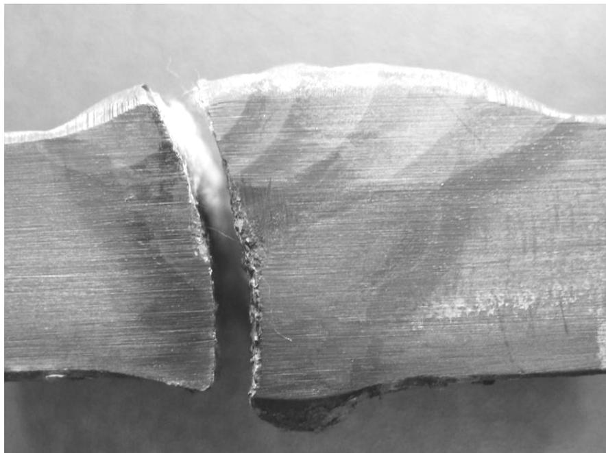
**Figura 4.13- Macrografia da junta soldada fraturada do corpo-de-prova CF 023, ensaiado a uma  $\Delta\sigma$  de 367 MPa no meio corrosivo, rompendo com um número de ciclos  $N = 59.100$  (Fratura na região do concentrador de tensões).**
