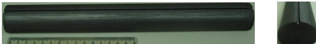
Figura 4.11. Fotografia longitudinal da base da barqueta, com detalhamento da ranhura na qual é inserido o termopar (1).
