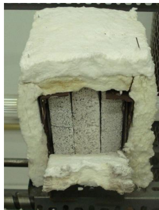
Figura 4.6. Fotografia do equipamento com detalhamento dos fornos resistivos.
