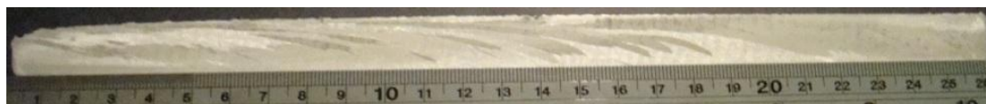
Figura 5.1. Fotografia da macrografia da porção 2 da amostra 11 (fim-início), com largura da zona fundida de 45%, velocidade de varredura de 4,3 cm/h e 5 passadas de zona fundida.
