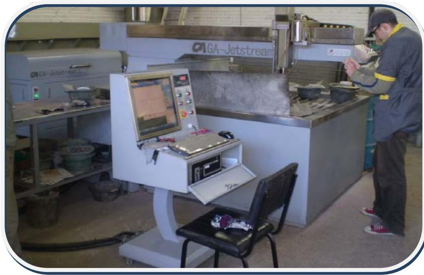
Figura 23. Equipamento para usinagem por jato d'água CNC da marca Jetstream.
