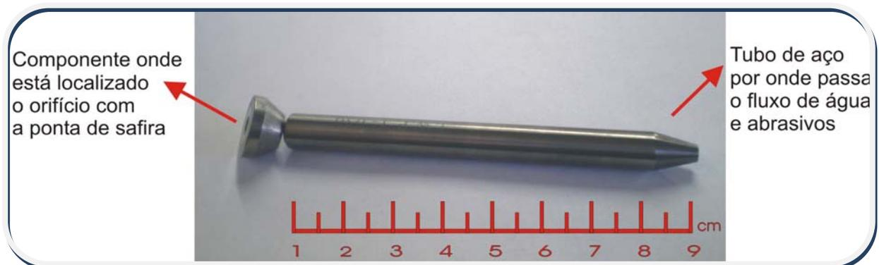
Figura 24. Componentes do equipamento de corte por jato d'água.
