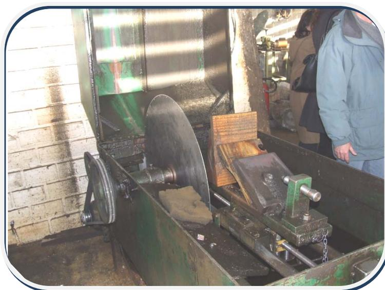
Figura 15. Imagem de equipamento para corte de geodos de ágata em chapas
