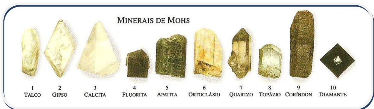
Figura 2: Escala de dureza dos minerais segundo Mohs. Classifica a capacidade de um mineral riscar outro relacionando com a dureza do mineral. Onde o diamante, número 10 na escala, é capaz de riscar todos os minerais abaixo dele e não é suscetível ao risco por nenhum deles; e o talco, mineral que apresenta a menor dureza na referida escala, é ser suscetível ao risco por todos os minerais acima e não apresenta dureza capaz de riscar os demais.
