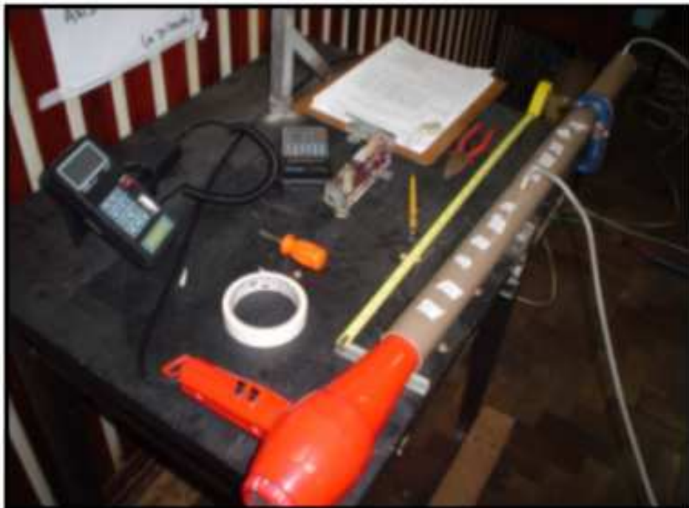
Figura 3.2 - Secador de Cabelo PARLUX. (Ensaio de fluxo de massa) (Fonte: Fotografia dos experimentos)
