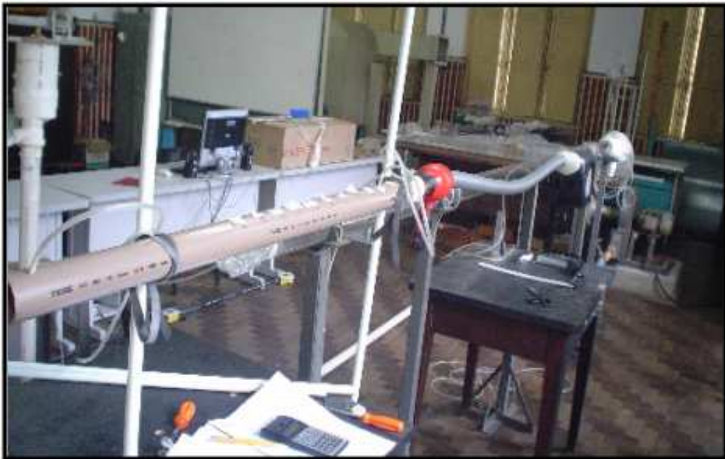
Figura 3.5 - Secador de Cabelo CONCEITO em ensaio de fluxo de massa no laboratório. (Fonte: Fotografia dos experimentos)
