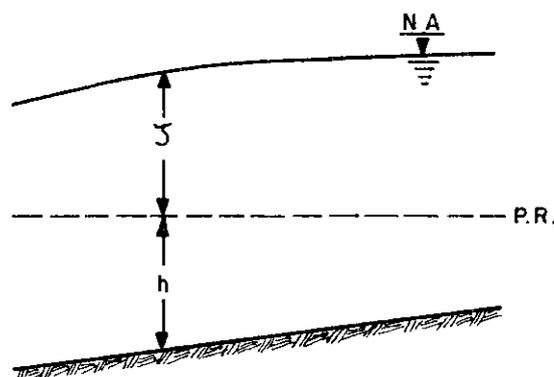
Figura IV.1 — Perfil vertical de integração
