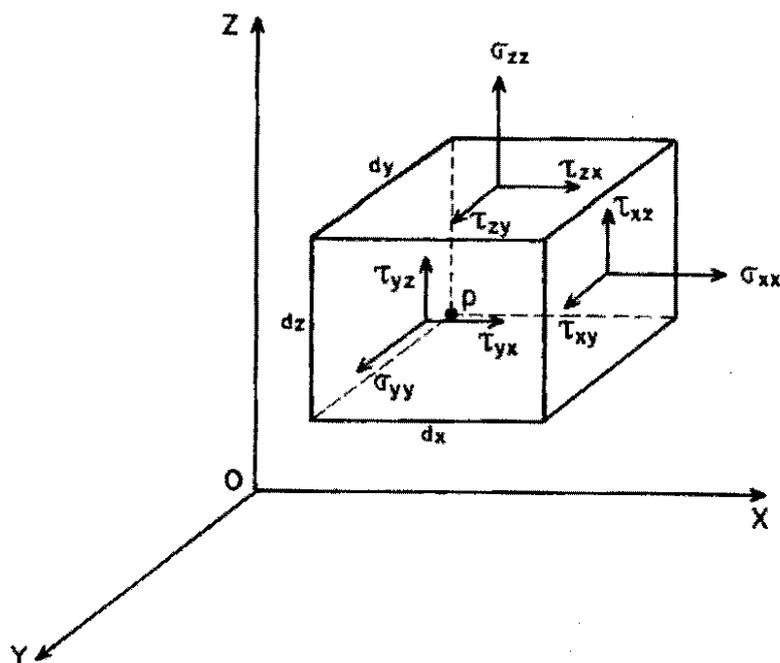
Figura II.1 — Tensões em um elemento de fluido.
