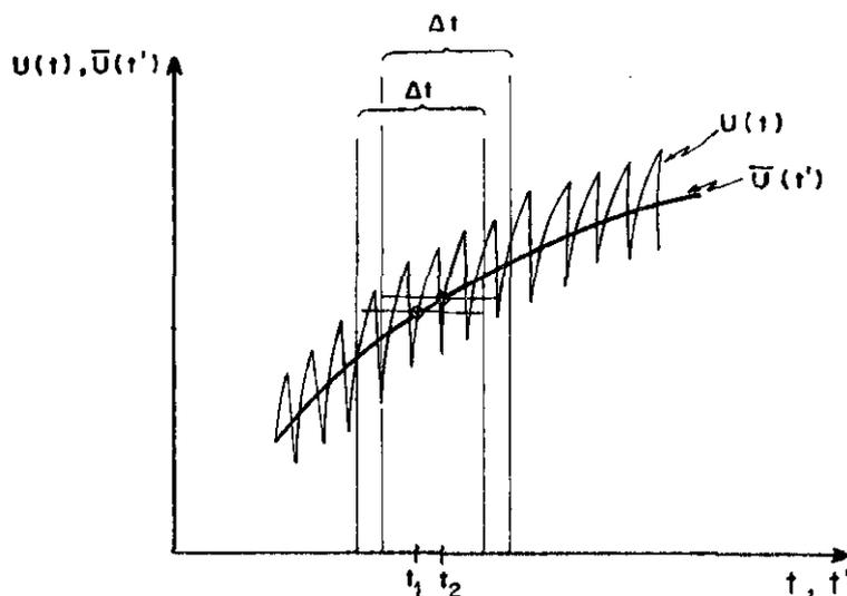
Figura III.2 — Flutuações turbulentas de velocidade
