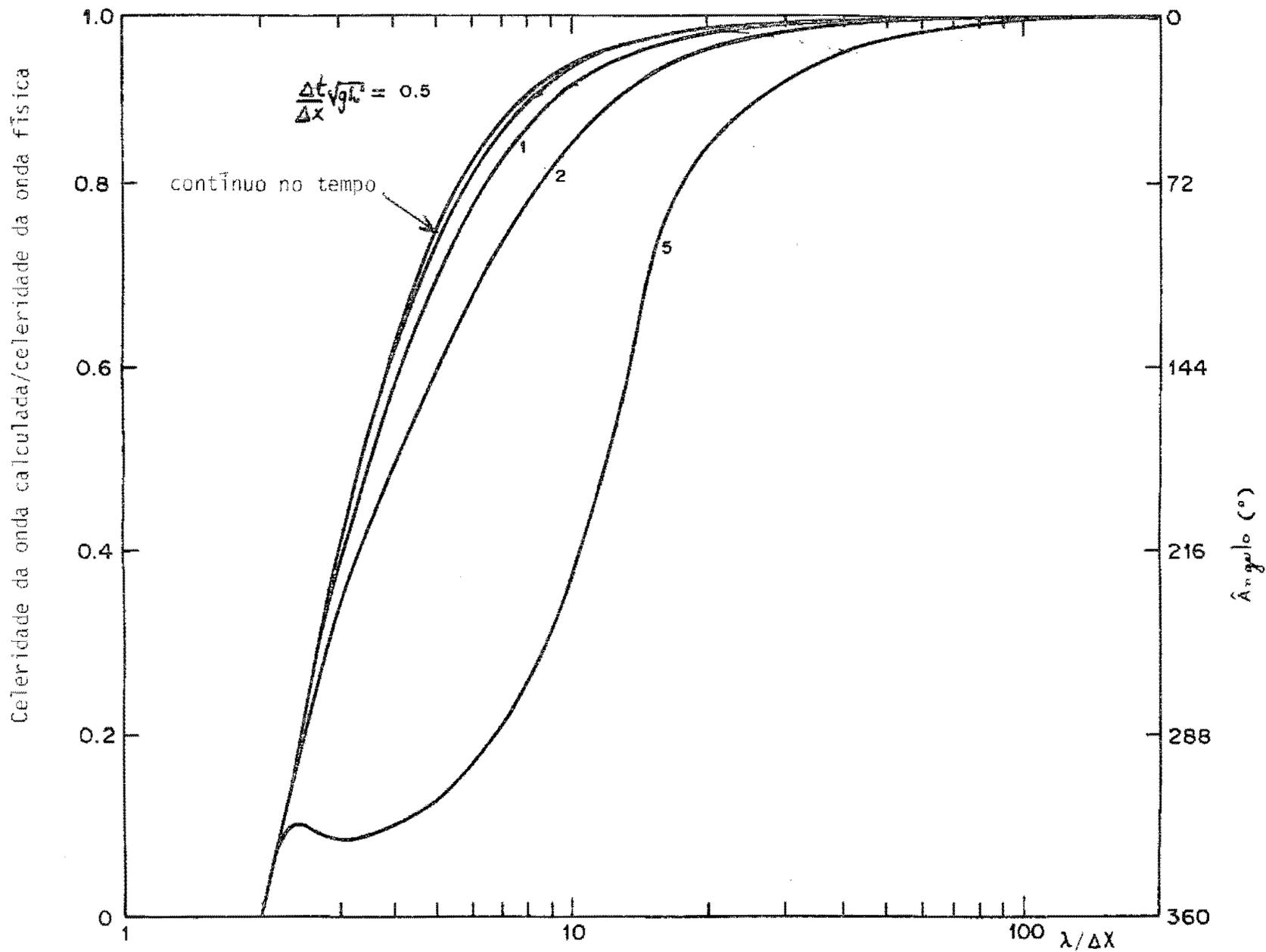
Figura V.7 — Deformação de onda no esquema centrado implícito (Leendertse, 1967)
