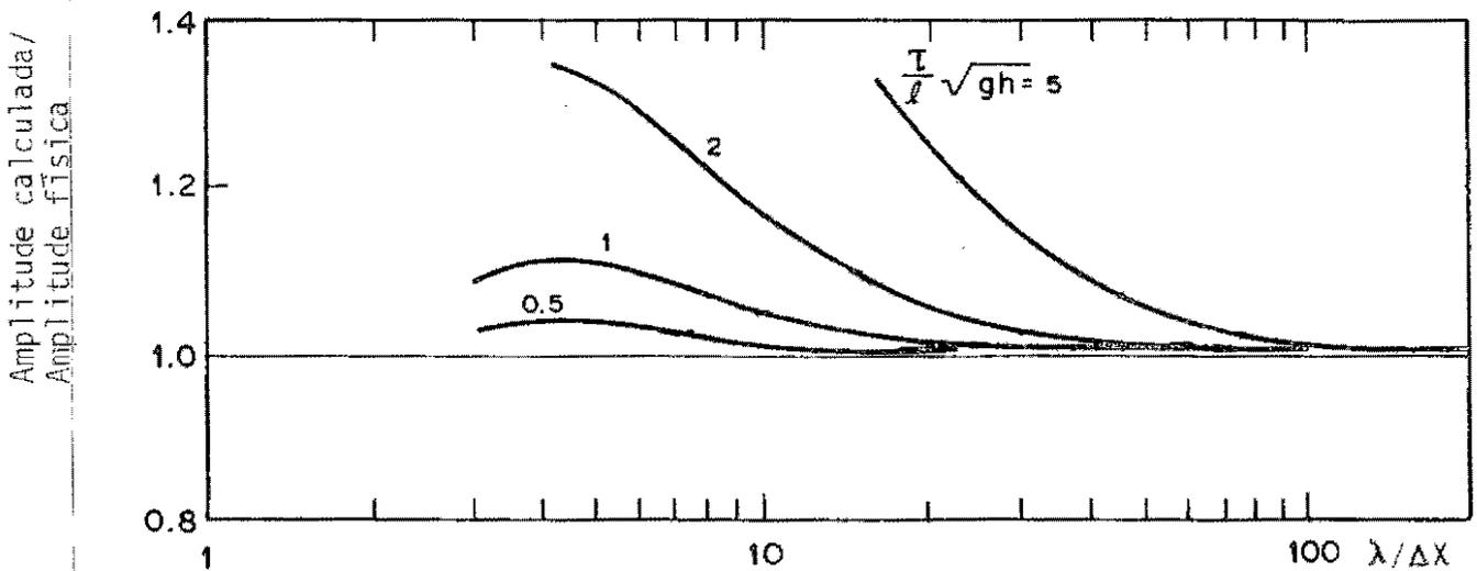
Figura V.11 — Amplificação de onda no esquema centrado implícito com rugosidade linear (Leendertse, 1967)
