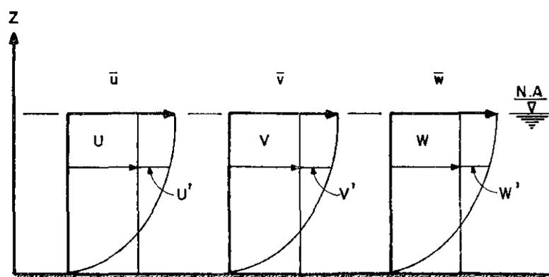
Figura IV.2 — Perfis das componentes de velocidade
