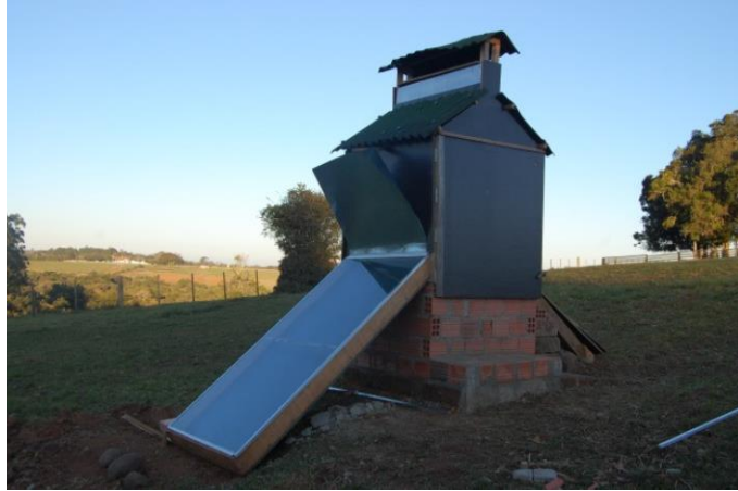
Figura 1.7 - Secador solar construído na Quinta da Estância.
