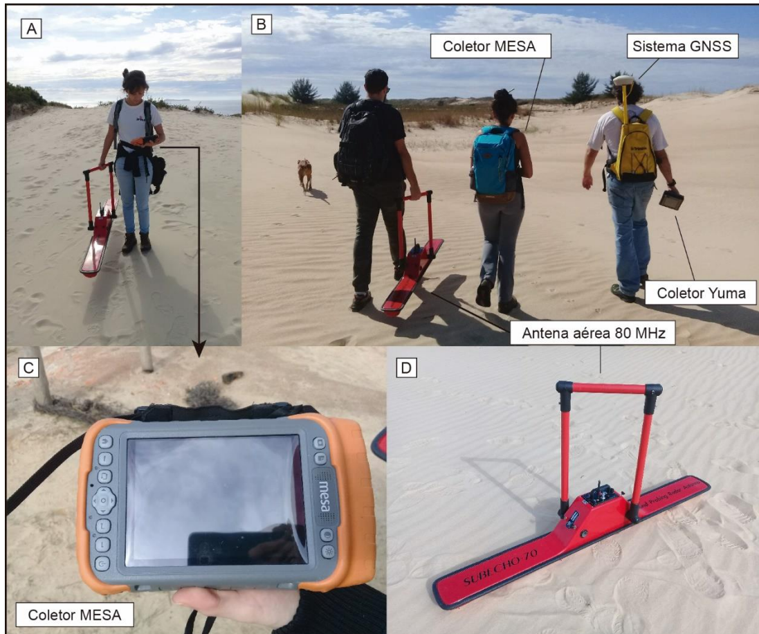
Figura 4 Equipamentos utilizados na coleta de dados com Georadar. Antena aérea de 80 MHz (A e D) e coletor Mesa (C). Sistema GNSS e Coletor Yuma (B) são utilizados em conjunto com o equipamento de Georadar, permitindo visualização e posicionamento das seções.
