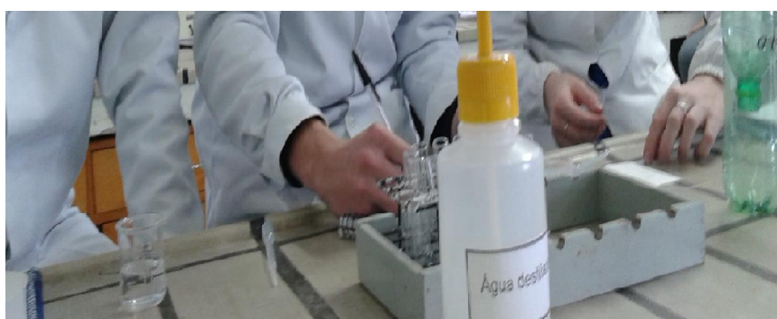
Figura 5. Realizando o tratamento da água com sulfato de alumínio
