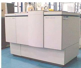
**Figura 3.5** Espectrômetro simultâneo de fluorescência de raios-X por comprimento de onda modelo PW 2600 da Philips.
