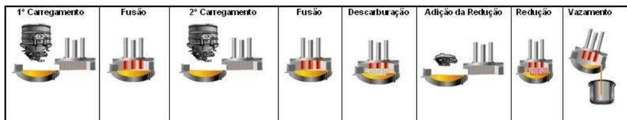
**Figura 2.9.** Seqüência de Operações na fabricação de aços inoxidáveis em Forno Elétrico à Arco (FEA). Ilustração do autor.
