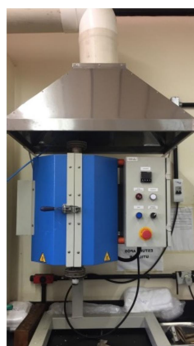
Figura 8. Forno convencional onde foram realizadas as pirólises referentes à Tabela 1.
