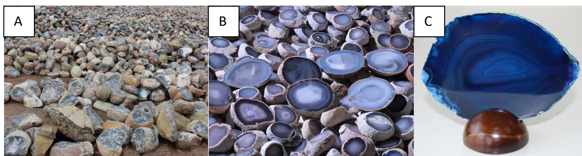
Figura 2.2 - Formas usuais de comercialização da ágata na região sul do Brasil. Em A) na sua forma bruta, geralmente usada para exportação; em B) cortadas em chapa grossa, lixada, sem tingimento, com espessura de aproximadamente 10 a 20 mm; em C) cortada em chapa fina, tingidas, lixadas e polidas, com espessuras de aproximadamente 5 mm. Adaptado de HL Minerais, 2018.
