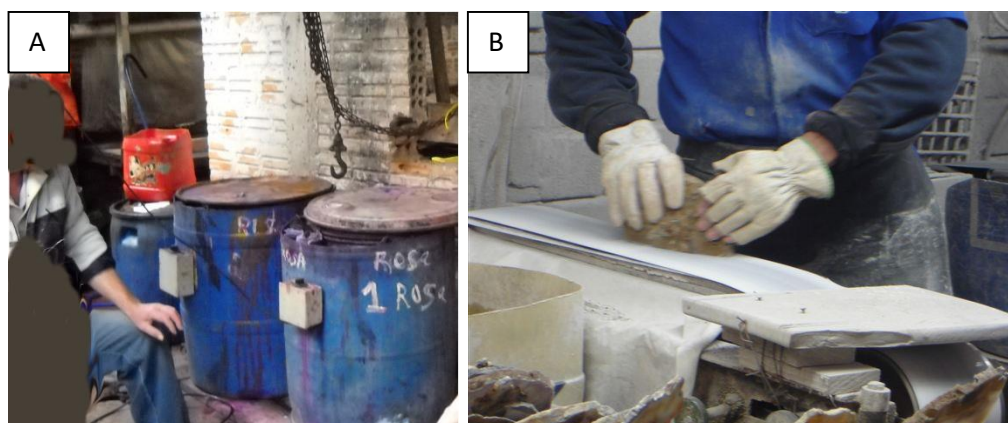
Figura 2.5 - Etapas da cadeia produtiva do beneficiamento da ágata. Em A) tingimento de ágata em pequena empresa de Soledade/RS; em B) processo de lixamento de uma base de ágata.
