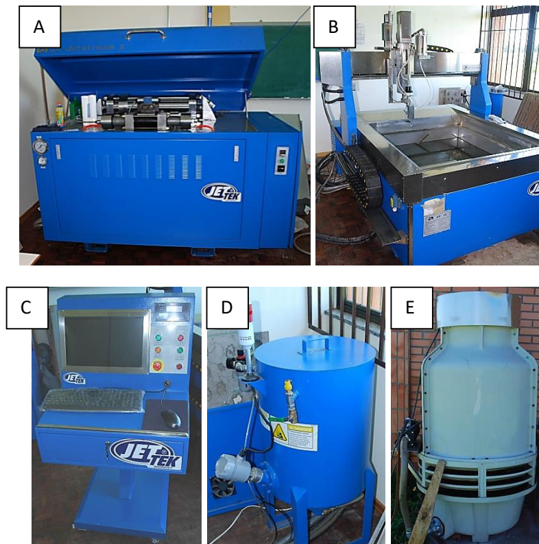
Figura 3.2 - Máquina de corte por jato de água abrasivo utilizada nos experimentos: em A) unidade de pressurização; em B) unidade de corte; em C) unidade de comando; em D) unidade de alimentação de abrasivo; em E) unidade de refrigeração.
