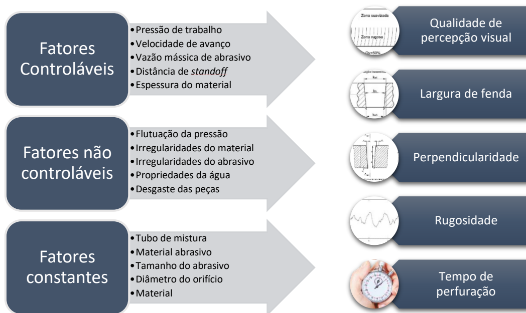
Figura 3.15 - Diagrama causa efeito para o processo de corte via AWJ.
