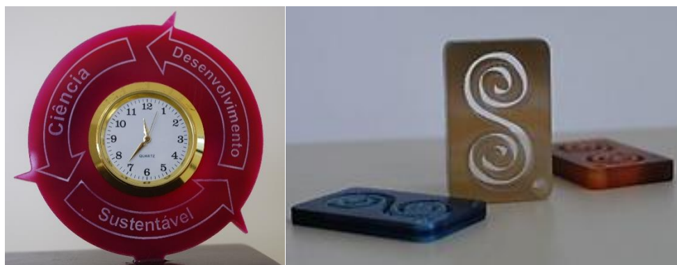
Figura 1.2 - Exemplos de produtos confeccionados em ágata a utilizando o processo AWJ.
