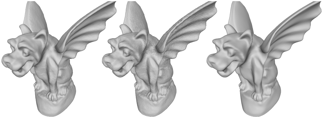
Figura 6.2: Filtragem de uma malha ruidosa. Na esquerda, a malha original. No centro, a malha ruidosa obtida a partir da malha original. Na direita, a malha filtrada com os parâmetros \sigma_s = 20 , \sigma_r = 0.1 e N = 3 .
