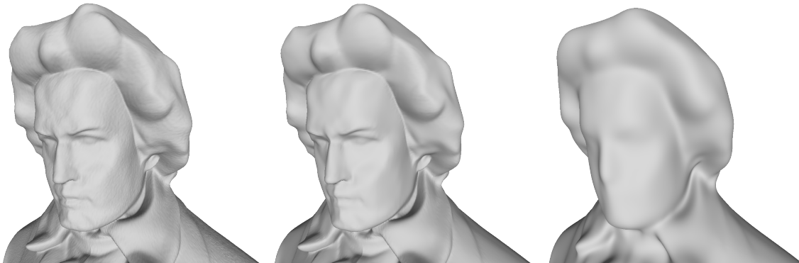
Figura 6.3: Filtragem de uma malha ruidosa. Na esquerda, a malha ruidosa. No centro, a malha ruidosa filtrada pelo filtro DTFSGIM com os parâmetros \sigma_s = 6 , \sigma_r = 0.065 e N = 3 . Na direita, a malha filtrada sem considerar informações de curvatura, ou seja, com \sigma_r \rightarrow \infty . Note como a filtragem com preservação de curvaturas gera um resultado que mantém mais informações sobre a malha original.
