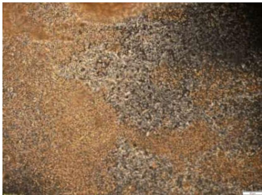
**Figura 47.** Imagem do filme de celulose modificada, obtida por MOLP a 136°C. Barra de escala: 10  $\mu\text{m}$ .
