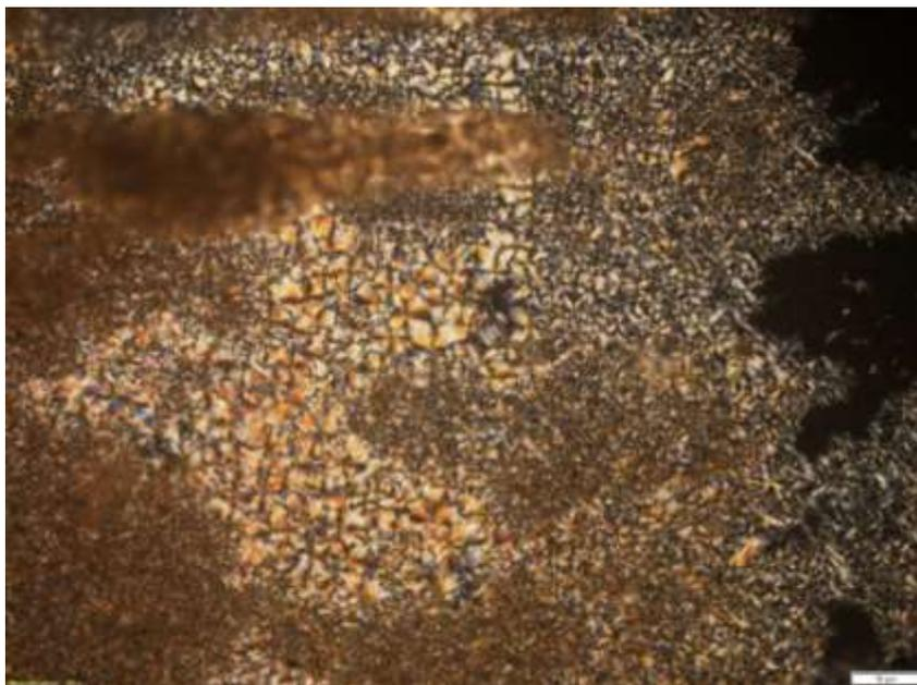
**Figura 45.** Imagem do filme de celulose modificada, obtida por MOLP a 95°C. Barra de escala: 10  $\mu\text{m}$ .
