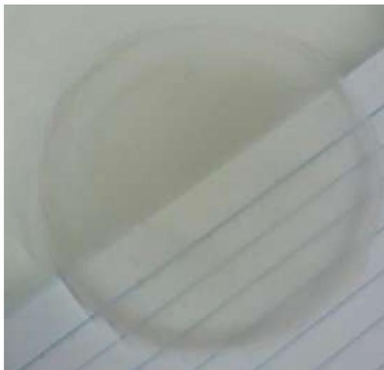
**Figura 20.** Filme de celulose produzido com a metodologia adotada.
