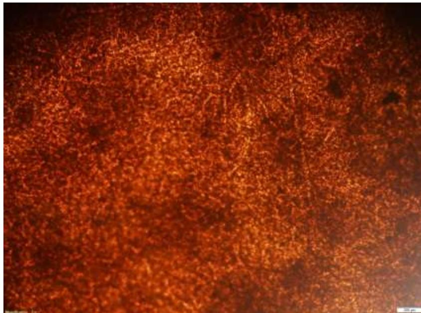
**Figura 40.** Imagens do filme de celulose pura, obtida por MOLP após primeiro aquecimento a 250 °C. Barra de escala: 200µm.
