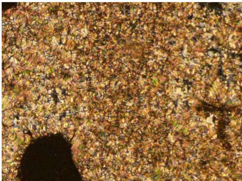
**Figura 43.** Imagem de uma amostra do cristal líquido CL-Br, obtida por MOLP a 25 °C<sup>45</sup>.
