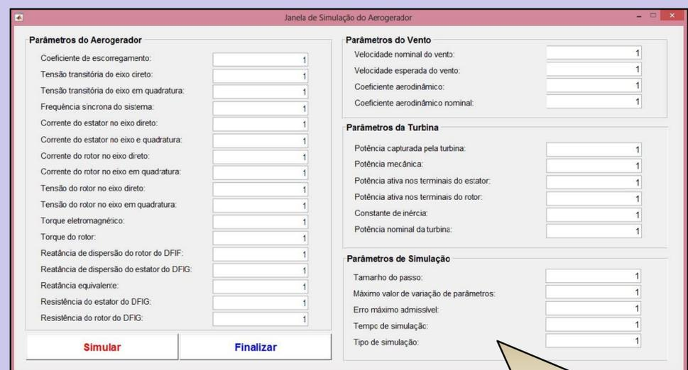
É possível alterar os parâmetros do aerogerador, do vento, da turbina e da rotina de simulação, para realizar diferentes tipos de simulações.
