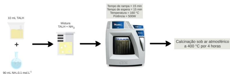
Figura 2: Fluxograma de síntese de  $\text{TiO}_2$  NPs via MWAC utilizando Titanium(IV) bis(ammonium lactato) dihydroxide (TALH) como precursor de Ti.
