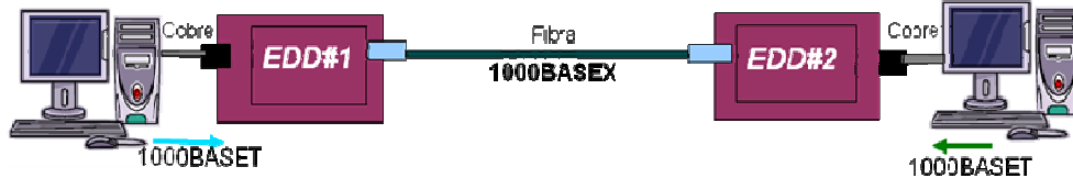
Figura 7.5: Testes de tráfego utilizando ferramenta “ Ping Flood ”
