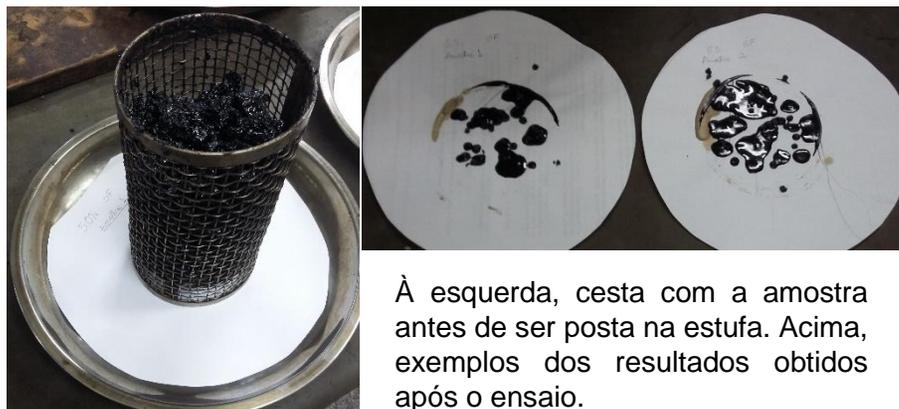
À esquerda, cesta com a amostra antes de ser posta na estufa. Acima, exemplos dos resultados obtidos após o ensaio.
