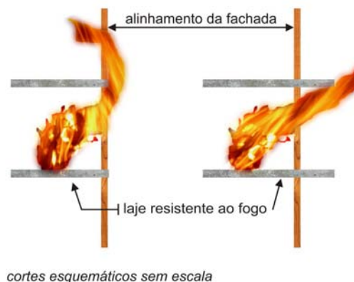
Figura 6: Demonstração esquemática do funcionamento da compartimentação vertical externa (Costa et al. , 2005)
