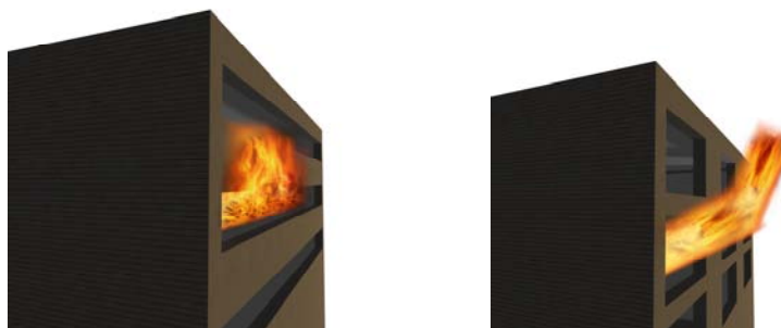
Figura 33: Desenho esquemático do comportamento das chamas conforme a geometria das aberturas, conforme proposto pelo Experimental Building Station apud Rosso (1975) .
