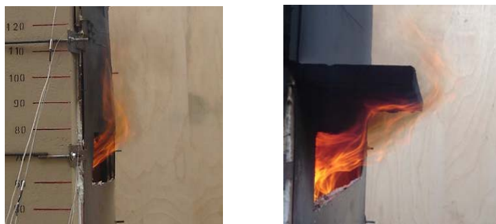
Figura 67: Ensaio sem (a) e com (b) projeção horizontal mostrando o “rebaixamento” das chamas ejetadas pela janela com configuração larga.
