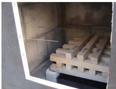
Figura 56: Posicionamento do engradado de madeira e dos termopares após a colocação da fachada.
