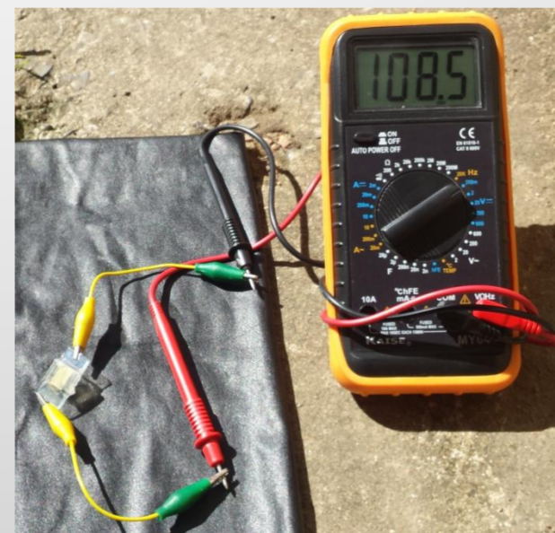
Figura 6: Célula exposta ao sol, mostrando foto resposta de 108,5 mV
