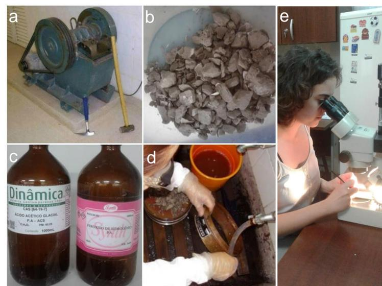
Figura 3: Metodologia. a) Desagregação física em britador de mandíbulas. b) Fragmentos de amostras. c) Desagregação química: ácido acético e peróxido de hidrogênio. d) Lavagem das amostras. e) Catação dos microfósseis em estereomicroscópio.
