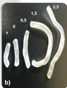
Figura 1: Resultados do ensaio de MFI das amostras de PP em função do teor de PPgAM: (a) índice de fluidez e (b) imagens das amostras após ensaio.
