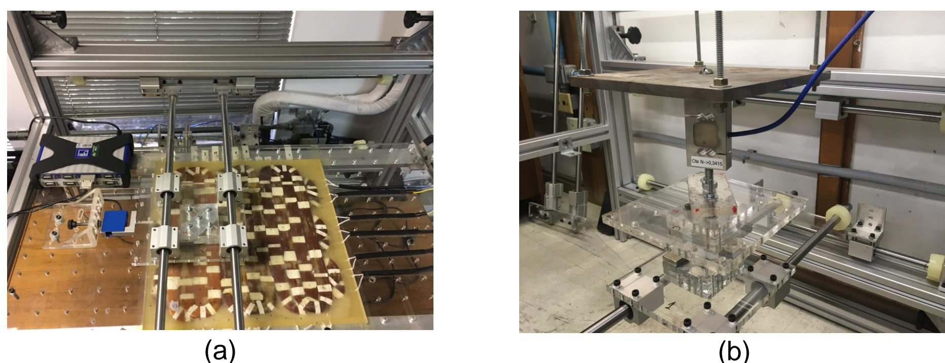
Figura 2. Arranjo para medição de (a) força de propulsão e de desacoplamento, e (b) para medição de força normal.
