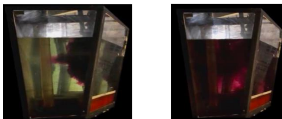
Figura 5: Vistas lateral do ensaio de escoamento para os tempos de 10 e 60s, na velocidade 2,3m/min
