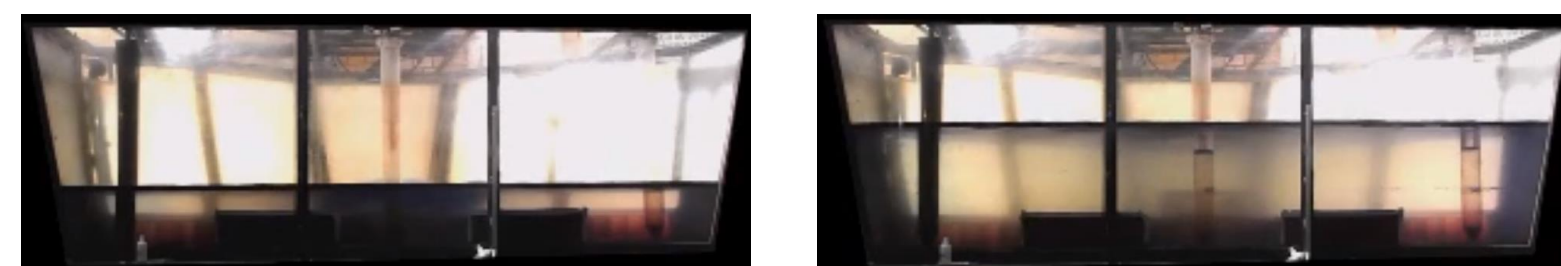
Figura 6: Vistas frontal do ensaio de emulsificação para os tempos de 2 e 120s, na velocidade 1,7m/min.
