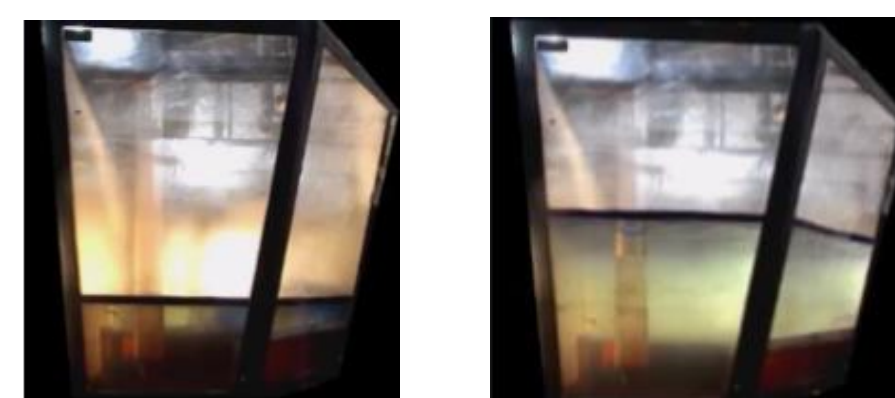
Figura 9: Vistas lateral do ensaio de emulsificação para os tempos de 2 e 120s, na velocidade 2,3m/min.
