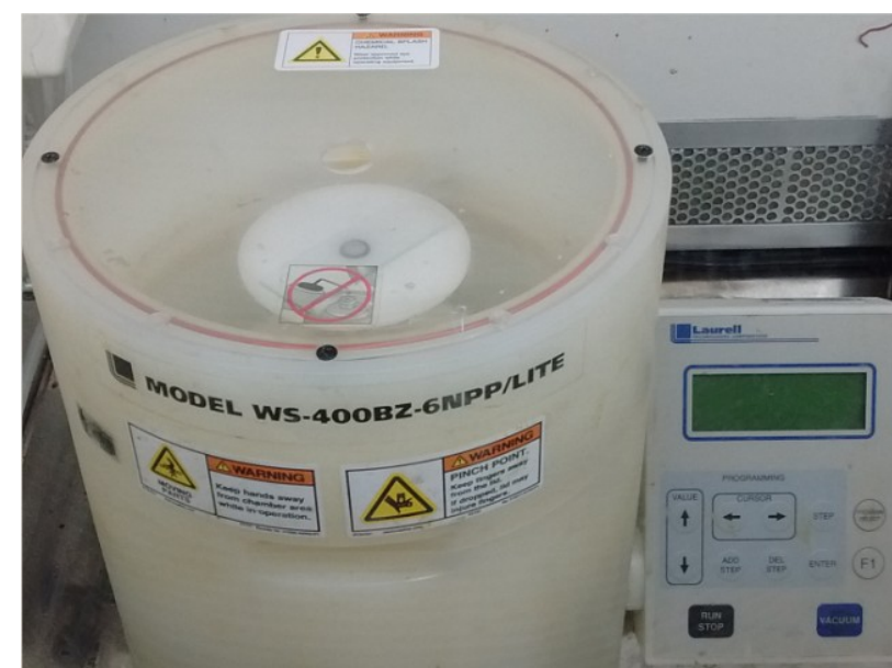
Figura 2: Spin-coater utilizado para deposição do fotorresiste.
