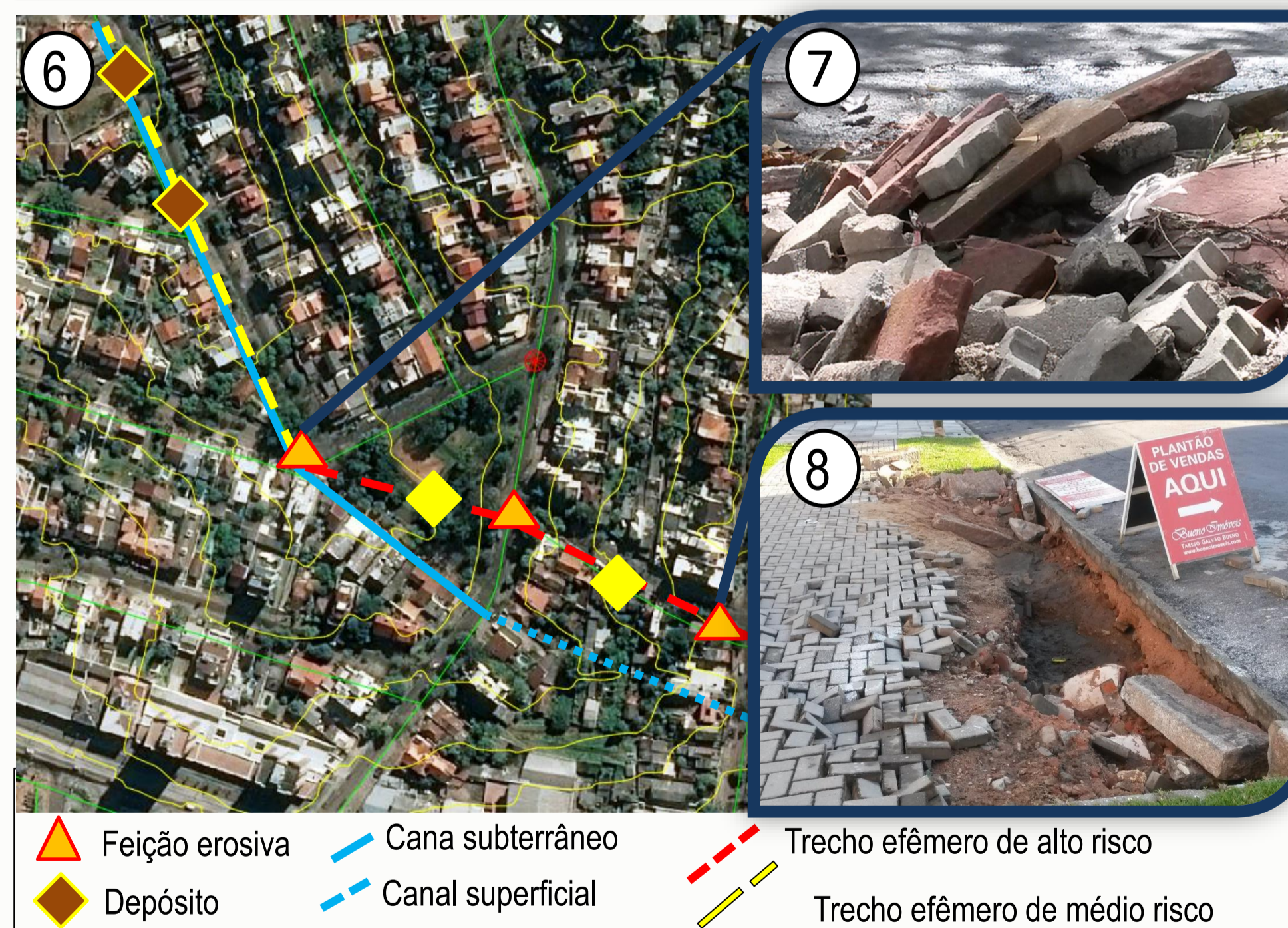
Figura 6: Mapa de depósitos sedimentares e feições erosivas. Figura 7: clastos imbricados Figura 8: feição erosiva com velocidade estimada superior a 21,66 km/h.
