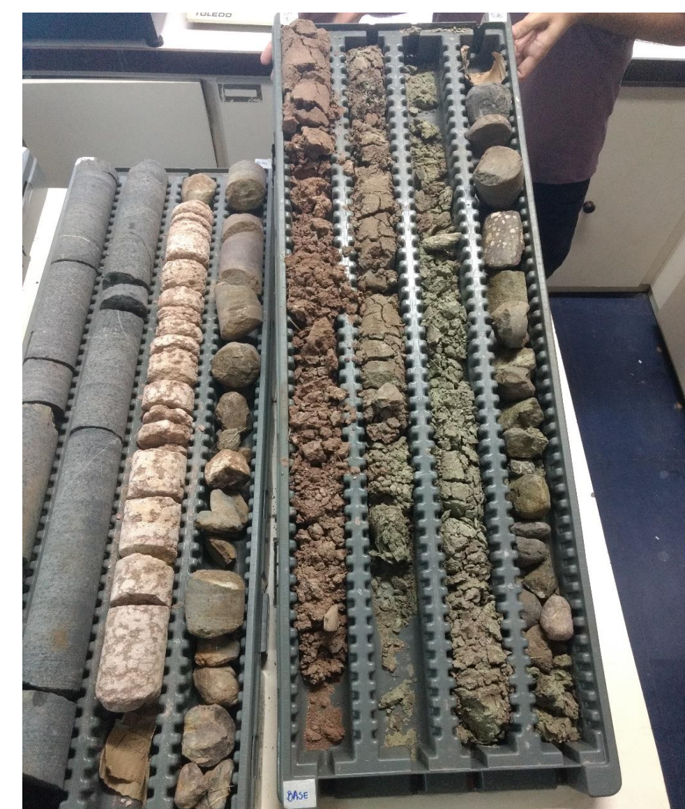
Fig. 3 – Foto do testemunho evidenciando porção de arenito e basalto muito alterado.
