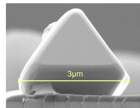
O recozimento dos filmes com o fim de torná-los policristalinos mostrou a inesperada formação de cristalitas micrométricas sobre toda a superfície das amostras, como mostrado na Microscopia Eletrônica de Varredura.
