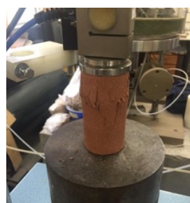
Figura 1: Ruptura do corpo de prova
