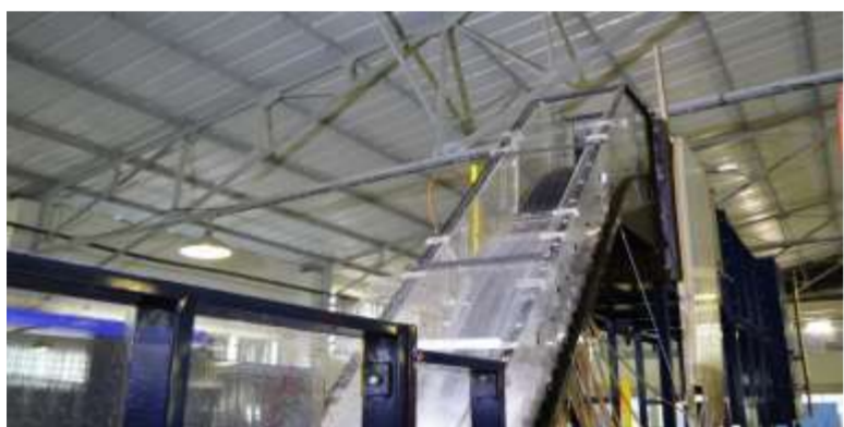
Modelo físico (MODELO LOH 1), localizado no Laboratório de Obras Hidráulicas LOH/IPH/UFRGS
