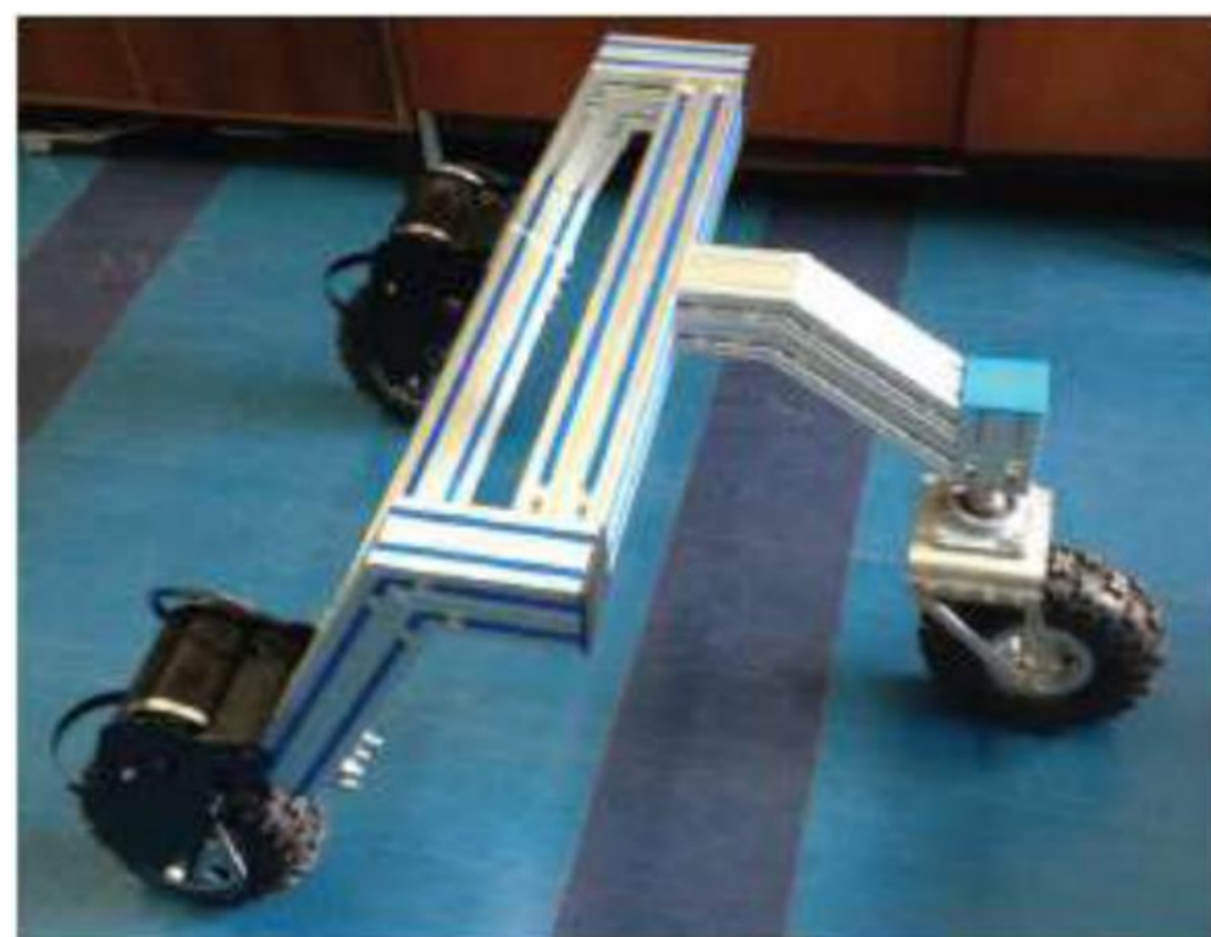
Figura 1: Estrutura do ROV desenvolvida.
