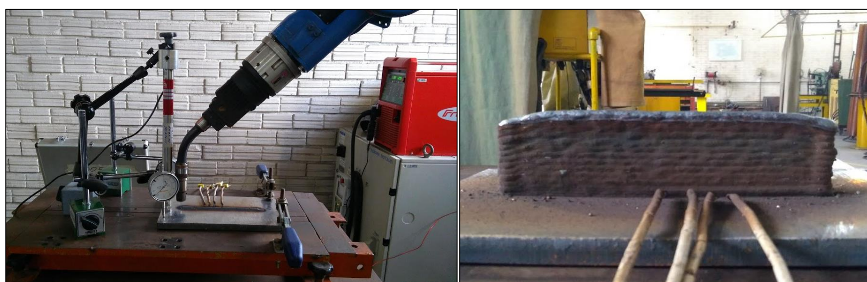
Fig. 1 – Aparato experimental (esq.) utilizado para o empilhamento dos cordões de solda (dir.).
