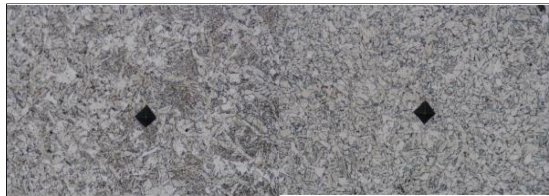
Fig. 5 – Micrografia revelando região de transição microestrutural. Aumento de 20x.
