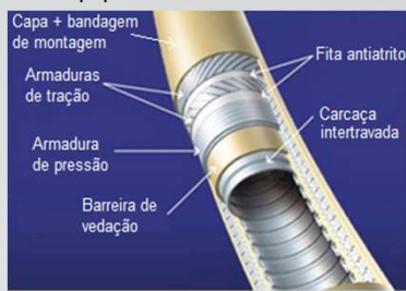
Figura 1: Camadas de um duto flexível. [adaptado de: Bai, Y., & Bai, Q., 2010, Subsea Engineering Handbook , Gulf Professional Publishing].
