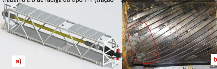
Figura 2: a) Modelo de bancada utilizada no ensaio de fadiga do tipo T-T. b) Fraturas nas armaduras de tração
