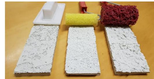
Figura 3 - Acabamentos superficiais das argamassas
