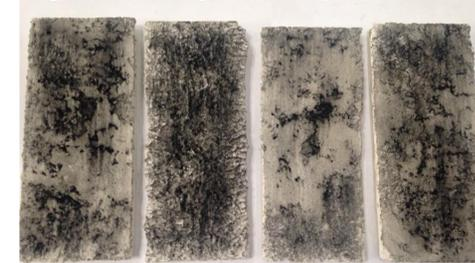
Figura 6 – Placas de argamassa com manchamentos de fuligem
