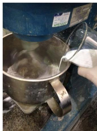
Figura 2 – Adição do  $TiO_2$  na mistura com argamassa
