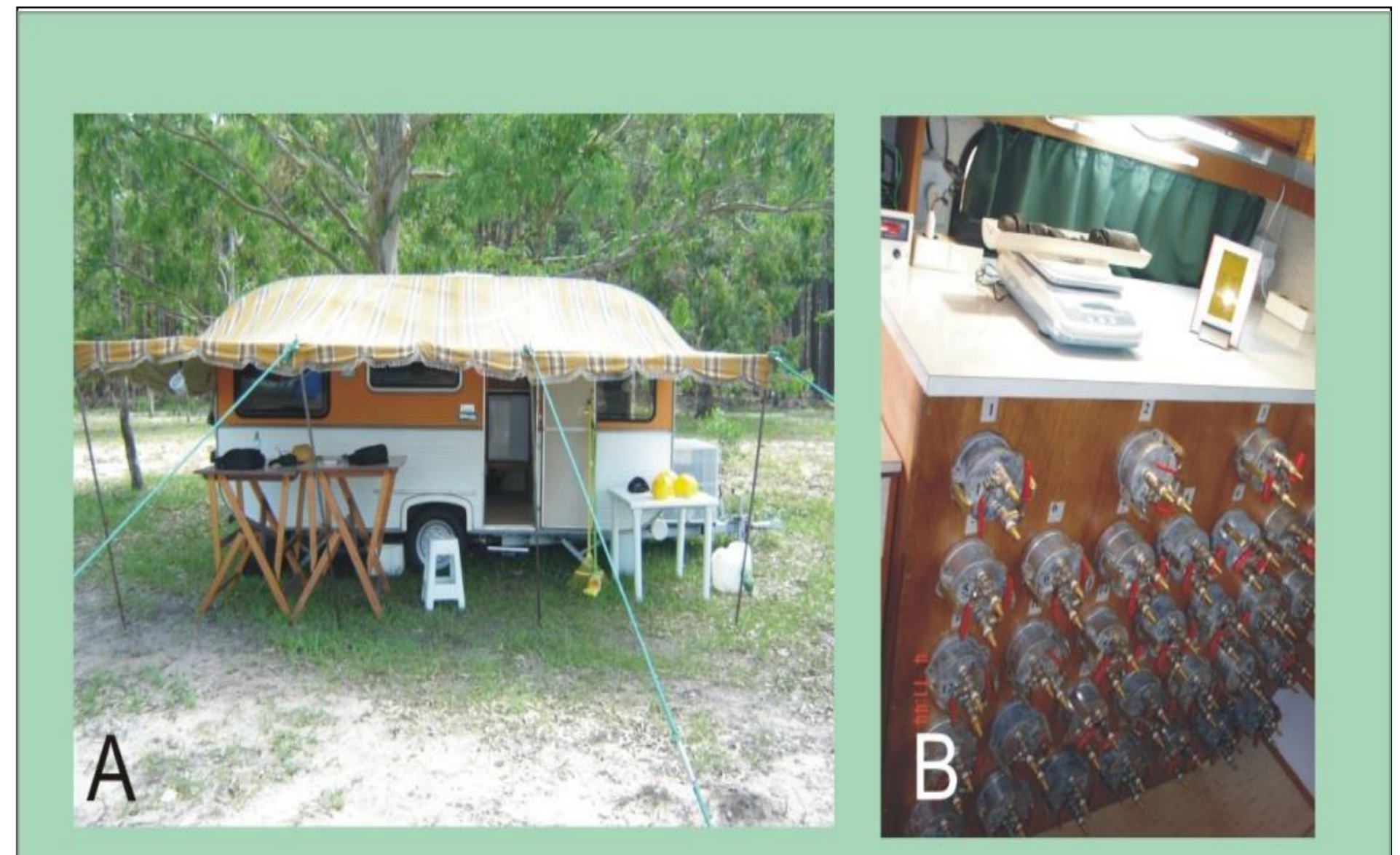
Figura 2. A) Laboratório móvel utilizado em campo; B) Cilindros contendo amostras de carvão para medidas de gás.
