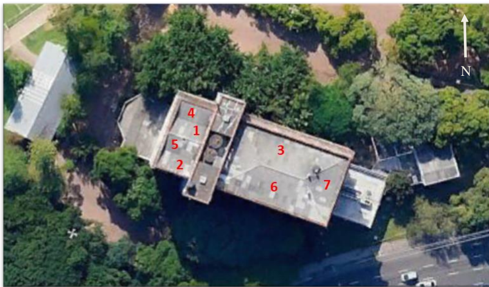
Figura 6 Áreas disponíveis para instalação do sistema solar fotovoltaico
