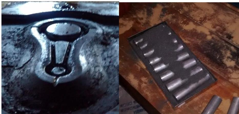
Figura 25 – Colocação do lubrificante na matriz - A e colocação do lubrificante no blank - B.
