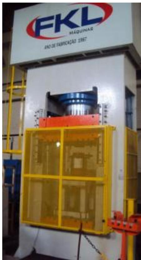
Figura 19 - Prensa hidráulica de 6 MN, marca FKL.
