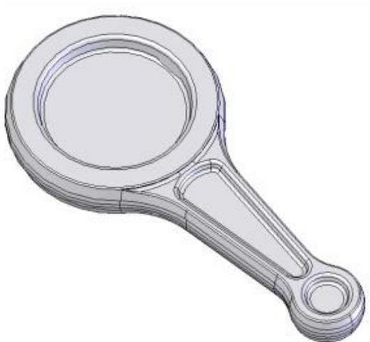
Figura 16 - Geometria final da peça forjada.
