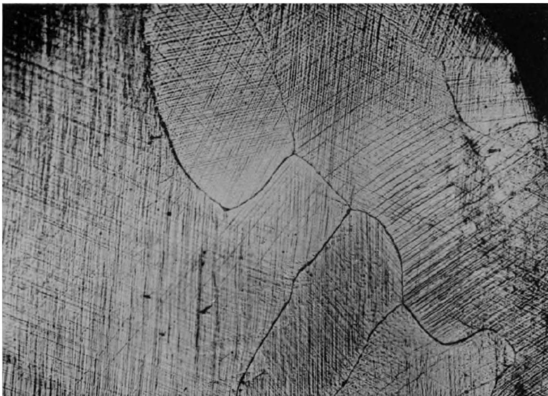
Figura 5 – Micrografia óptica de um policristal de chumbo após a deformação. Fonte: Ewing e Rosenhain (1900, p. 362).
