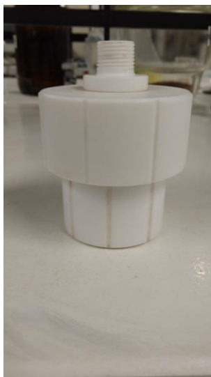
Figura 13. Reator de Teflon utilizado para a síntese de AgNPs.
