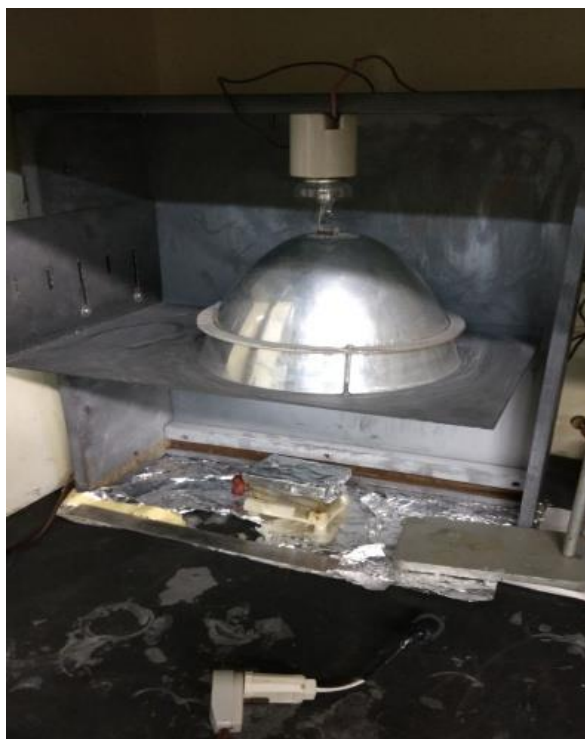
Figura 14. Lâmpada de meia pressão utilizada na fotólise das amostras de PSU.
