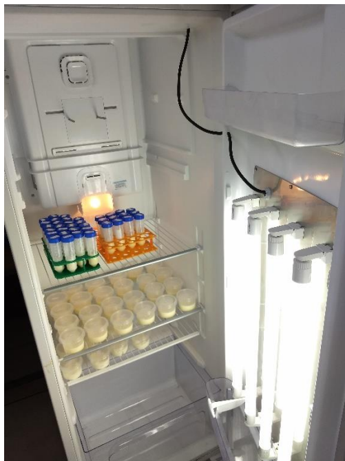
Figura 22. Amostras de iogurte armazenadas em câmara BOD (4 °C) para o teste de estabilidade.
