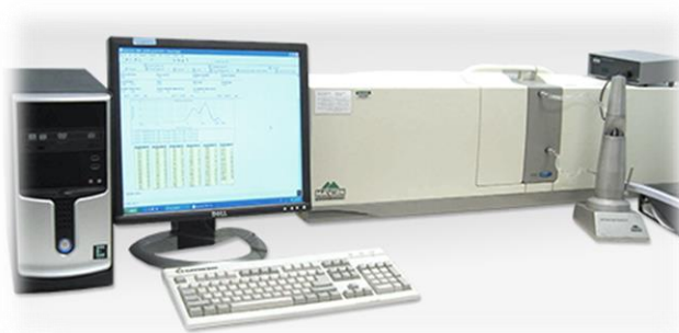
Figura 12 - Equipamento Mastersizer utilizado para medir diâmetro da partícula e valor de span.
