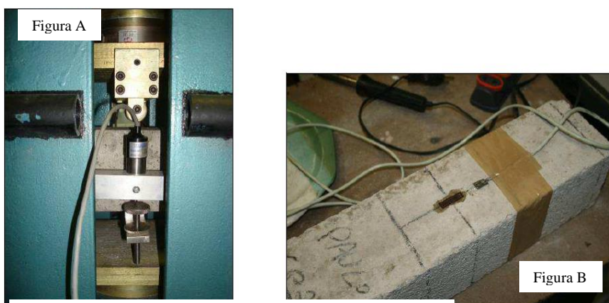
Figura 28 - Corpos de prova prismático com medições por LVDT no centro do vão da vigota (Fig-28A) e com strain gage fixado na face inferior (Figura 28B).
