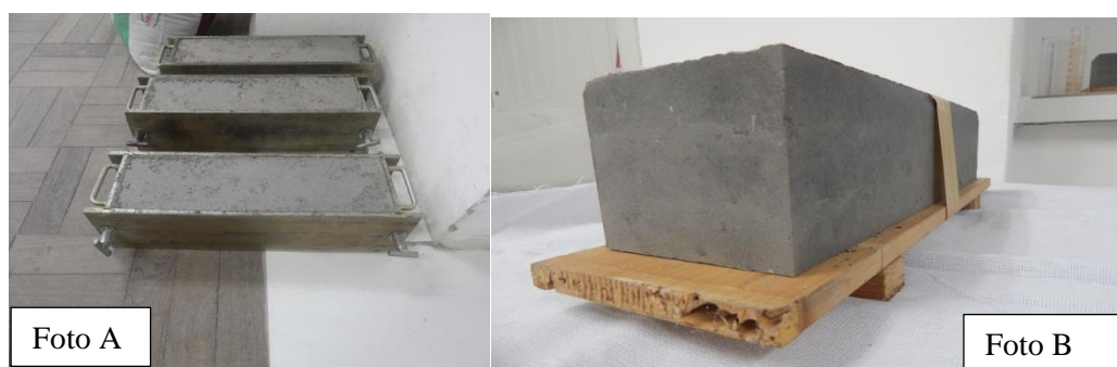
Figura 94 – Foto A (repouso por 48 horas) e foto B (desmoldagem e suporte de madeira) .
