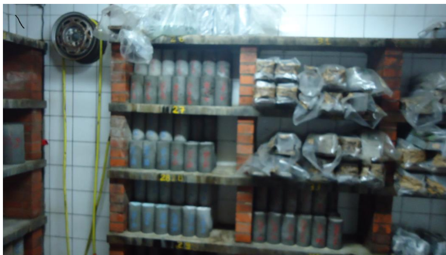
Figura 78 – Câmara úmida com temperatura de 23±2°C e umidade relativa de 95%
