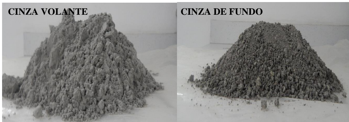
Figura 52 - Fotos das cinzas volante e de fundo da Termelétrica Presidente Médici – fase B
